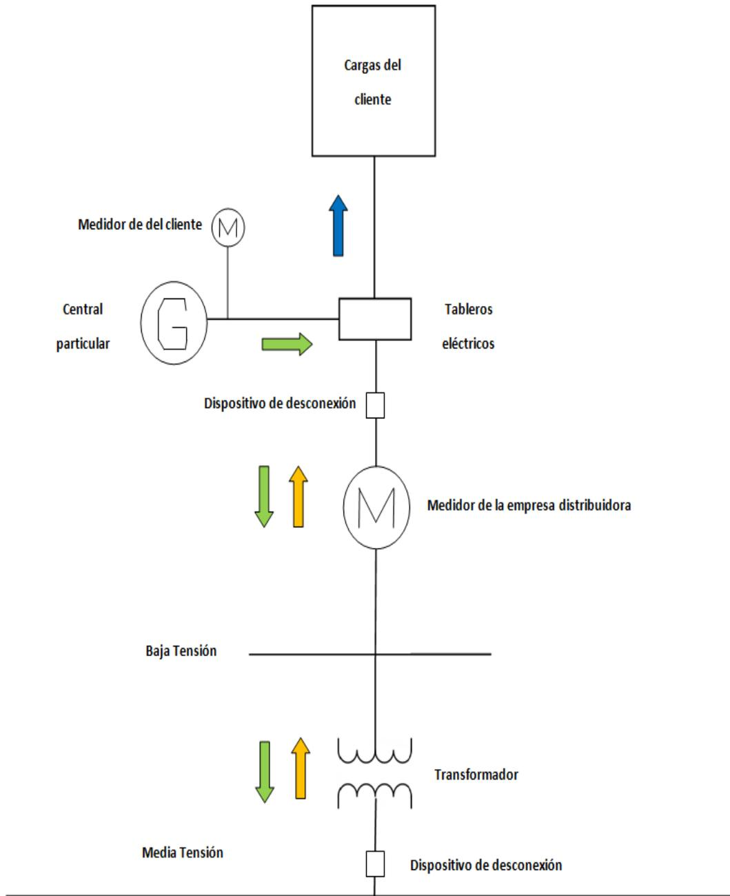
Sistema de autoconsumo con capacidad instalada menor a 500 kW
