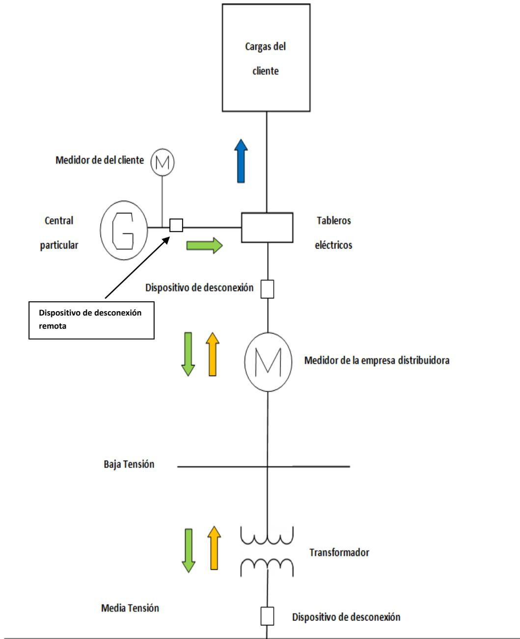
Sistema de autoconsumo con capacidad instalada mayor a 500 kW
