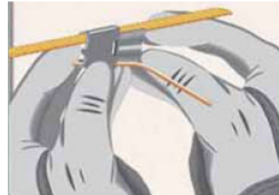
Figura N°11, Instalación de Cuña entre Conductores
