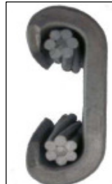
Figura N°3, Cables colocados en componente C
