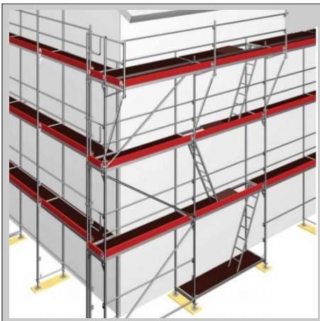
Andamio de fachada
